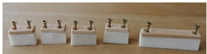
Abbildung 64: Zugentlastungen Marke Eigenbau
